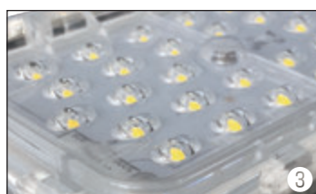
③ 多配列パターン。グレアを抑えるために、多くのLEDを配置できます。
